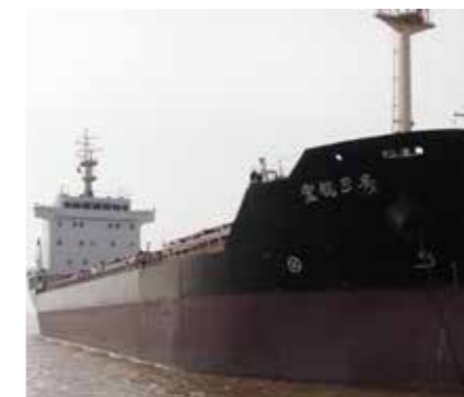
MS Michelle Draagvermogen: 8000 ton DWT LxBxD: 116 x 17 x 7 meter Snelheid: 12,5 knopen
